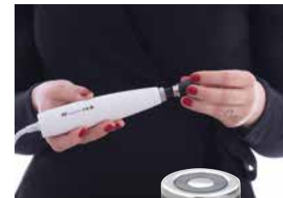
Testa Emissione R.F. Bipolar Viso. Diametro 2,5 cm
